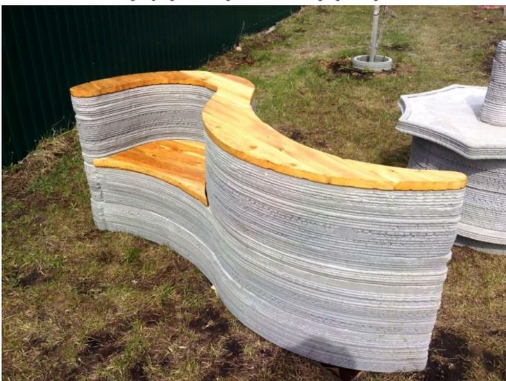
О принтере]] - Принтер S-6045 - улучшенная модель малоформатных принтеров серии S, разработанная на базе [S-6043](#) позволяет печатать различными по составу бетонами, в том числе стандартными составами на основе цемента серии 500, т.е. тем, что есть в свободной продаже на любом строительном рынке и использовать смеси с минеральными добавками и
